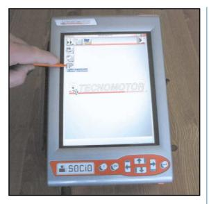
della doppia freccia accediamo alla pagina di setup dello strumento. Qualora fosse collegato l'analizzatore gas o il modem per la connessione alla rete di internet la relativa icona sarebbe attiva.
